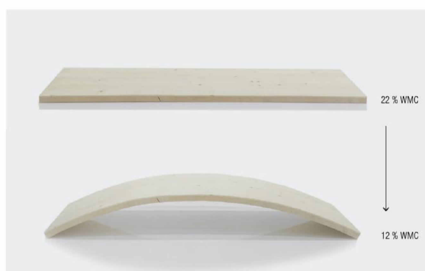
Рисунок 10. Деформация панели с изменением процента влажности
